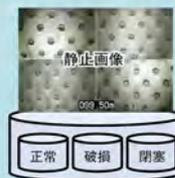
◆井戸内映像をAIを用いて「正常」「破損」「閉塞」に自動で分類し静止画像にして抽出
