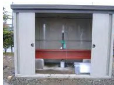
地下水位・地盤沈下観測井戸
